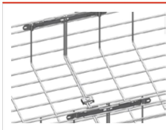
网格快速连接条拼接是免螺丝安装,能快速的连接槽体,牢固可靠,配合网格卡扣组件使用也能适应于承重要求高的槽体对接。
