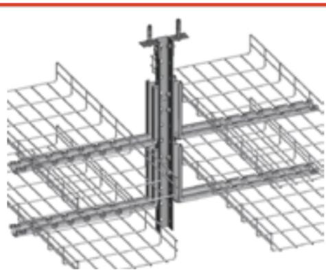
用 2 个 L 件，2 个膨胀，2 个 M8×14 六角法兰螺栓和 2 个六角法兰螺母将 U 型立柱固定在天花板上。
