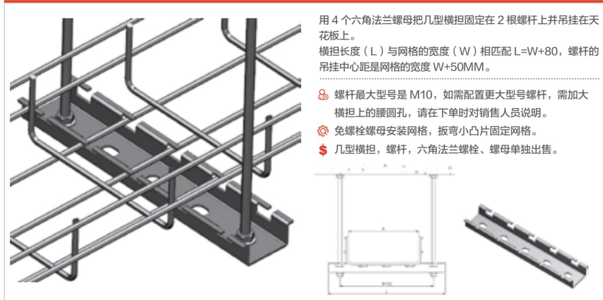
用 4 个六角法兰螺母把几型横担固定在 2 根螺杆上并吊挂在天花板上。
