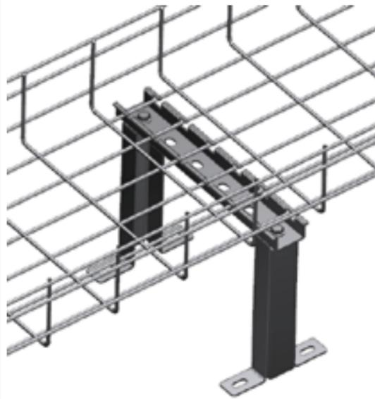
桥型支撑组件是由2个几型支撑座, 1个几型横担, 2个M8×16六角法兰螺栓和2个M8六角法兰螺母组成。
