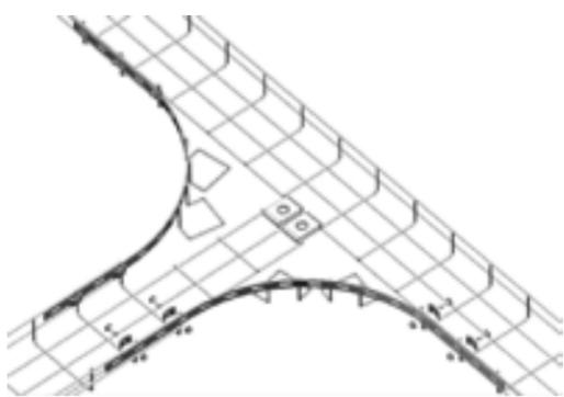
网格 R300 连接件组件是由 1 个 R300 连接件，4 个 M6×20 马车螺栓，4 个内卡，4 个 M6 法兰螺母组成。
