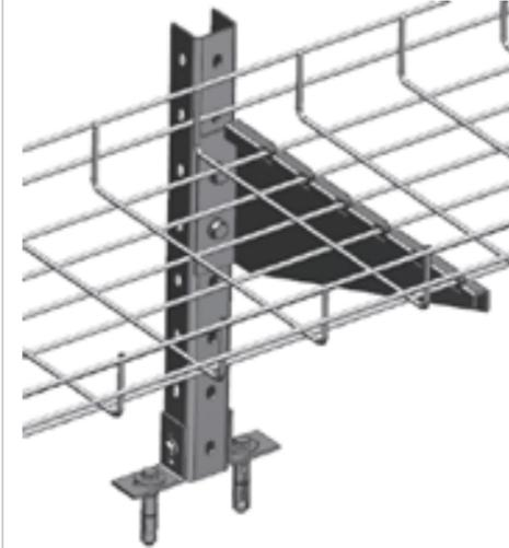
用2个L件, 2个膨胀, 2个M8×14六角法兰螺栓和2个六角法兰螺母将U型立柱固定在地面上。
