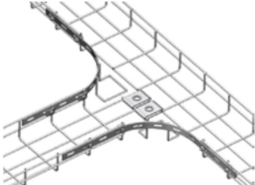
网格 R140 连接件组件是由 1 个 R140 连接件，4 个 M6×20 马车螺栓，4 个内卡，4 个 M6 法兰螺母组成。
