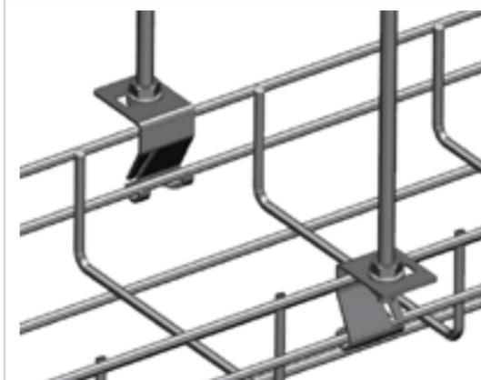
★ 用 2 个网格吊钩通过六角法兰螺母和螺杆把网格桥架吊挂在天花板上。
