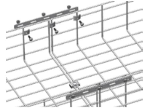
网格加强条组件由1个网格加强条, 3个内卡, 3个 M6×20 马车螺栓和3个 M6 法兰螺母组成。
