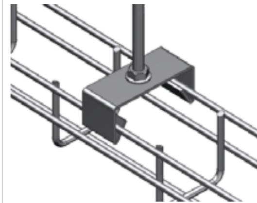
用 2 个六角法兰螺母把 50 网格吊挂件固定在 1 根螺杆上并悬挂在天花板上。专门为 50 宽的网格桥架设计的吊挂件, 免螺栓螺母安装, 只需把钩子扳弯就可固定网格桥架。
