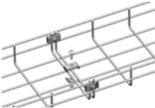
卡扣组件是由1个外卡, 1个内卡, 1个 M6×20 马车螺栓和1个 M6 法兰面螺母套组成。
