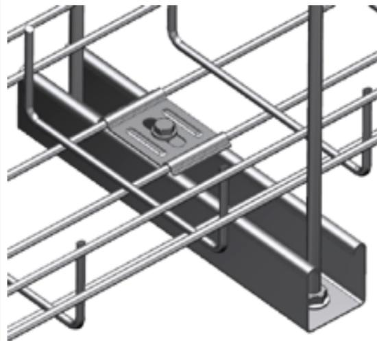
用 4 个六角法兰螺母把 C 型横担固定在 2 根螺杆上并悬挂在天花板上。需用压片，外卡，六角法兰螺栓和六角法兰螺母来固定网格。横担长度 (L) 与网格的宽度 (W) 相匹配,  $L=W+80\text{MM}$ , 螺杆的吊挂中心距是网格的宽度  $W+30\text{MM}$ 。
