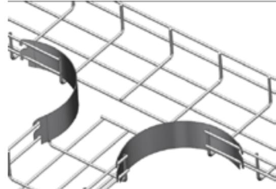
网格圆弧挡板是由 0.8MM 厚金属薄板弯曲成任意圆弧卡到网格两头的侧边上。
