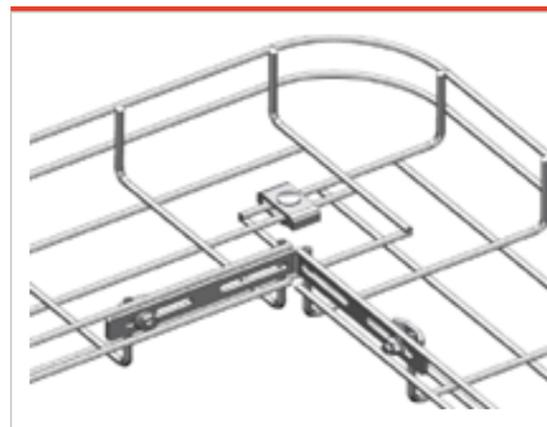
网格 L 形连接件组件是有 1 个 L 形连接件, 2 个内卡, 2 个 M6×20 六角法兰螺栓和 2 个 M6 六角法兰螺母组成。
