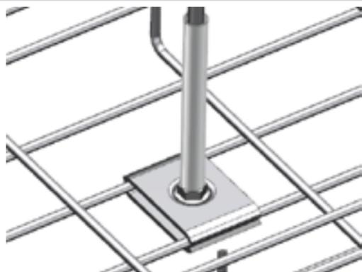
用 2 个法兰螺母把 2 个中心卡扣对叠固定在螺杆上，通过中心卡扣堆叠夹紧的方式来固定网格。
